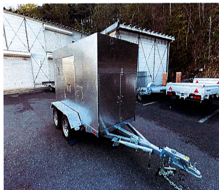
備品No.7.電源トレーラー
